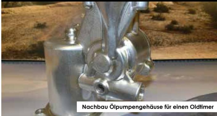
Nachbau Ölpumpengehäuse für einen Oldtimer
